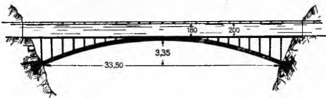
Sl. 6. Shema akvedukta u klišuri Aragonskog melioracionog sistema (Španija)
