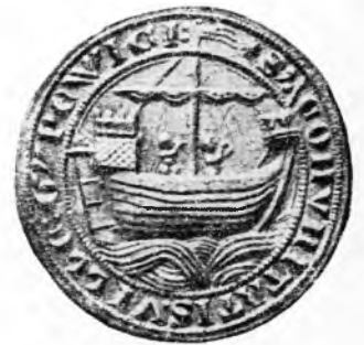
Sl. 2. Prikaz broda s kormilom iza krme (pečat grada Ipswicha, XIII st.)
