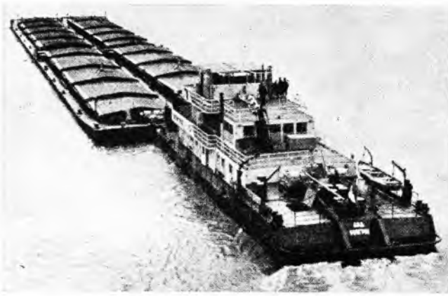
Sl. 17. Jugoslavenski gurač »Deligrad« ( L_{OA} = 39 m, B = 9 m, T = 1,7 m, maksimalna snaga 1500 KS) sa sastavom od četiri 1000-tonske teglenice
