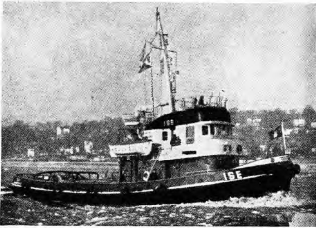
Sl. 13. Dizel-električni lučki tegljač »Isc«; L_{pp} = 24 m, B = 7,2 m, T = 3,6 m, snaga pogonskog uređaja 675 KS
