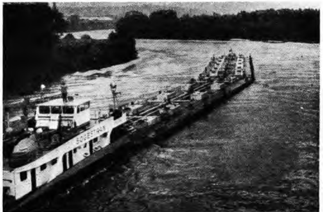
Sl. 19. Gurački sastav sa samopodesivnim zglibno-elastičnim vezama teglenica
