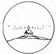
Sl. 13. Slika u stereoskopskom daljinomjeru s lebdećom markom
