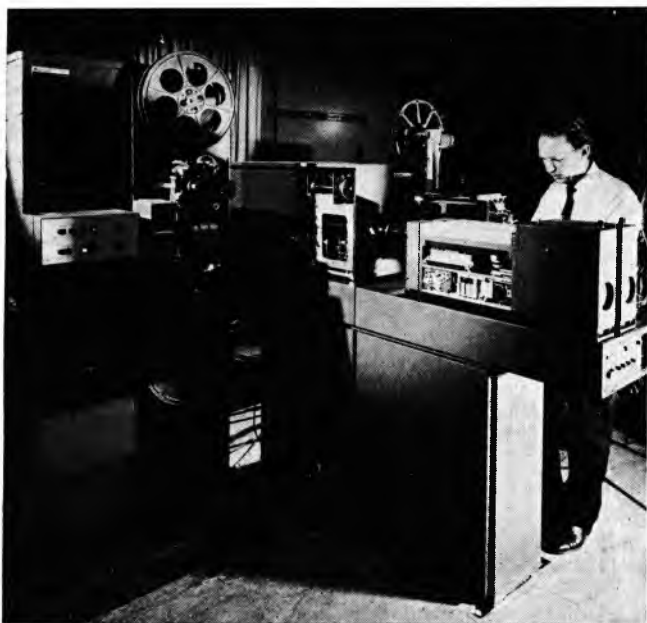
Sl. 82. Telekino. Lijevo projektor za film širine 35 mm, straga projektor za film širine 16 mm; na desnoj strani dva dija-projektora, a u centru kamera za snimanje kromatske televizije sa sistemom za preklapanje optike
