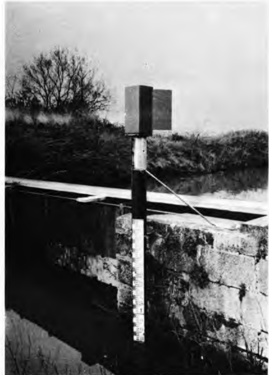
Sl. 6. Automatski registrator razine vode (protočni tip) s vodomjernom letvom
