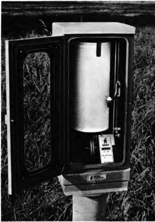
Sl. 3. Limnograf s vertikalnim bubnjem
