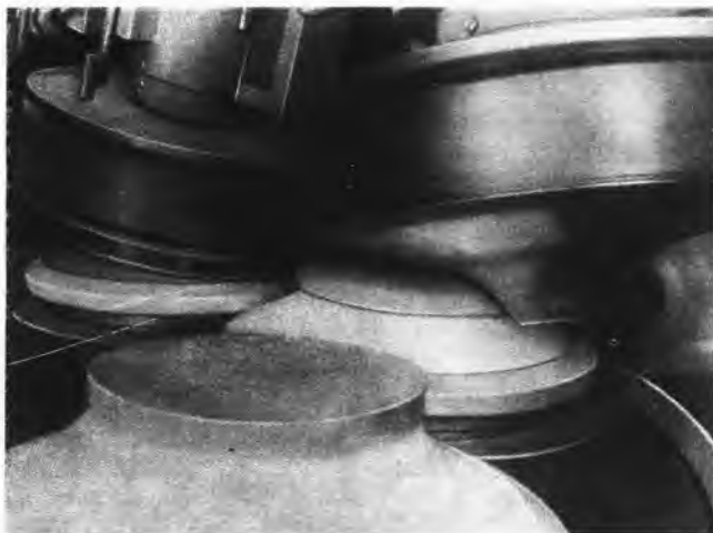
Sl. 3. Detalj automatskog uređaja za tokarenje tanjura (tokarske glave)
