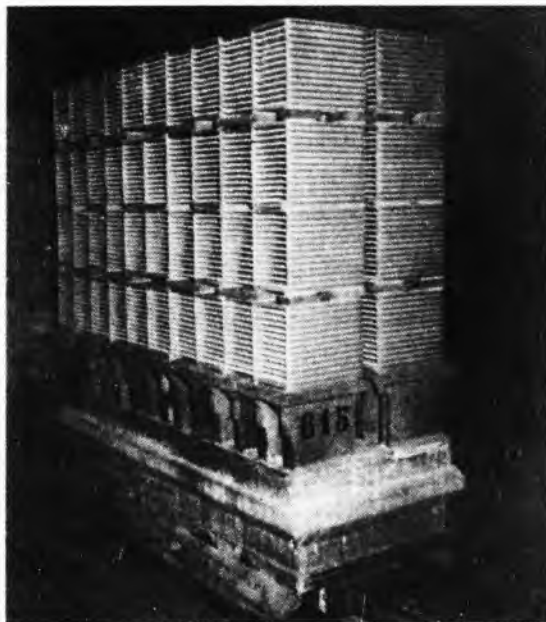
Sl. 20. Glazirane pločice u kasetama za pečenje na pećnim kolicima
