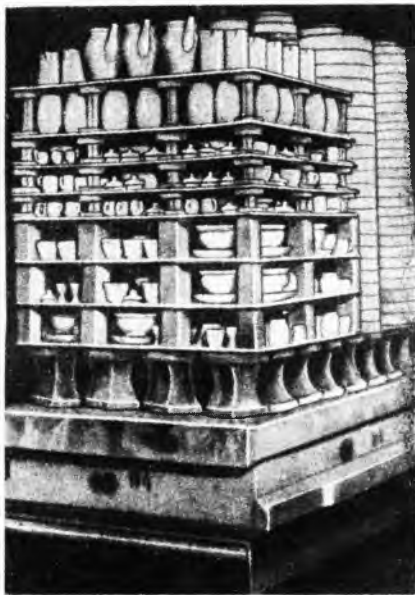
Sl. 12. Kombinirano slaganje robe u kapsulama i regalima pećnih kolica
