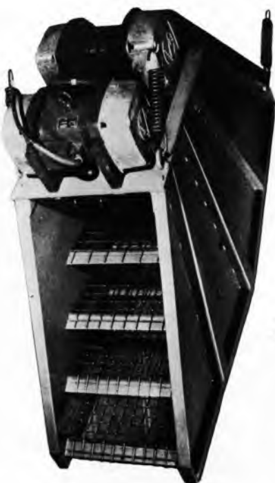
Sl. 19. Mogensen sizer, princip rada (gore) i izvedba (lijevo)
