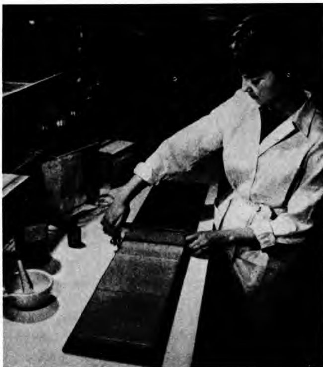
Sl. 12. Priprava tankog sloja pomoću uređaja Stahl-Desaga
