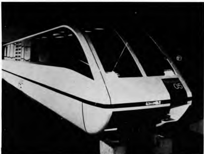
Sl. 36. Lebdeće pružno vozilo Transrapid 05 tvrtke Krauss-Maffei. Dimenzije: duljina 26,3 m, širina 3,1 m, visina 3,5 m. Masa 36 t. Kapacitet 72 putnika. Zagon sinhronim linearnim elektromotorom maksimalne vučne sile 25,2 kN. Brzina 90 km/h
