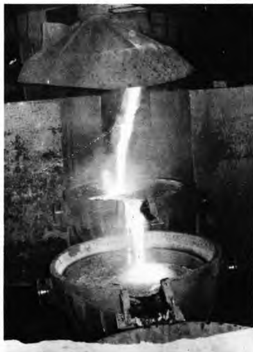
Sl. 1. Odvajanje rastaljenog mangana od troske u tvornici karbida i ferolegura »Dalmacija« u Dugom Ratu
