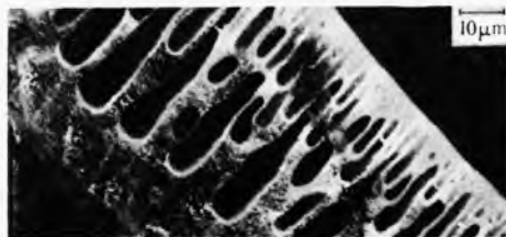
Sl. 7. Snimka graničnih struktura membrana dobivenih inverzijom faza. a pjenasta struktura jedne membrane od acetata celuloze (gornja strana), b prstasta struktura jedne membrane od poliamidskog materijala (donja strana)
