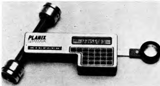
Sl. 17. Planimetar s elektroničkim brojiлом i mikroprocesorom
