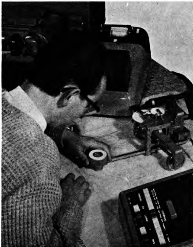
Sl. 18. Računanje površina kombiniranom (polugrafičkom) metodom
