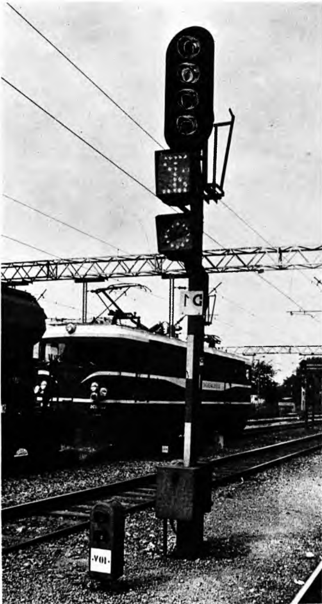
Sl. 11. IZLAZNI signal s pokazivačima smjera i brzine kao dopunskim signalima. Pokraj njega uz tlo se nalazi i manevarski signal
