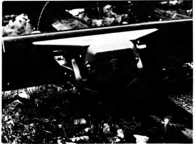
Sl. 12. Pružni tračnički kontakt željezničkog prometa
