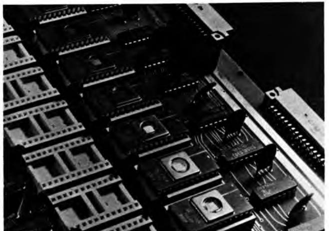
Sl. 18. Dio elektroničkog uređaja za daljinsko upravljanje željezničkim prometom
