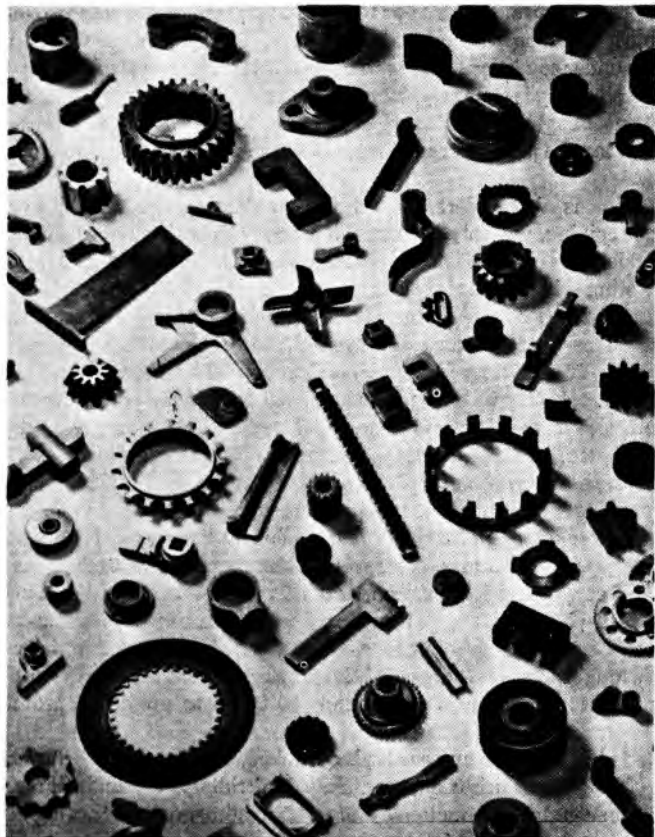
Sl. 13. Neki strojni elementi proizvedeni procesima sinterske metalurgije
