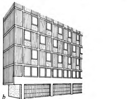
Sl. 4. Prihvatni nosači: a u obliku podvlake, b u obliku nadvlake, c u obliku okvirnog nosača
