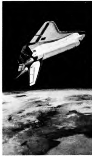
Sl. 10. Ulazak orbitera u putanju oko Zemlje (visina ~185 km, brzina ~28300 km/h)
