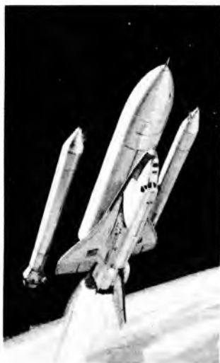
Sl. 8. Space shuttle; odvajanje pomoćnih raketa (visina ~46 km, brzina ~5000 km/h)
