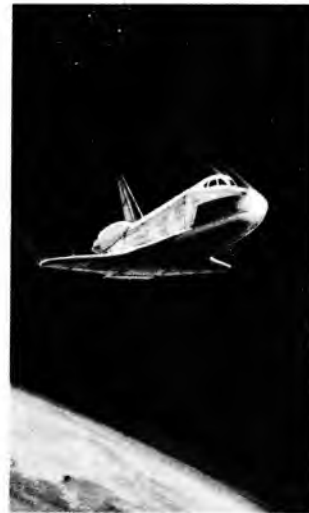
Sl. 11. Ulazak orbitera u Zemljinu atmosferu (visina ~122 km, brzina ~26800 km/h)
