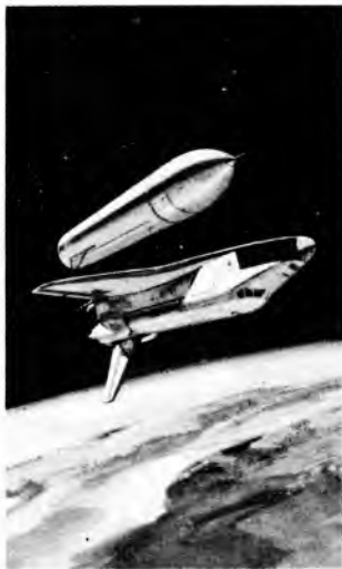
Sl. 9. Space shuttle; odvajanje vanjskog spremnika za gorivo
