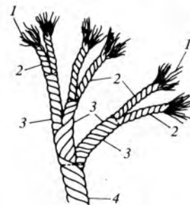
Sl. 2. Šesteronitna kordna pređa. 1 vlakno, 2 jednonitna pređa uvijena u smjeru S, 3 dvonitna pređa uvijena u smjeru Z, 4 kordna pređa
