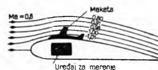
Sl. 4. Ispitivanje u okozvučnoj oblasti na polumodelima
