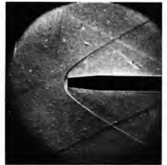
Sl. 27. Snimak udarnog talasa pomoću šliren-uređaja u nadzvučnom aerotunelu
