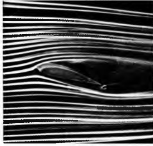
Sl. 14. Opstrujavanje oko aeroprofila krila u dimnom aerotunelu
