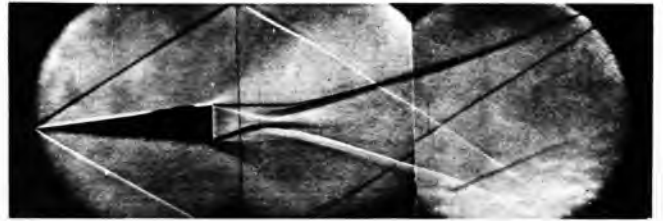
Sl. 26. Strujanje oko klina sa pojavom udarnih talasa pri opitu u nadzvučnom aerotunelu
