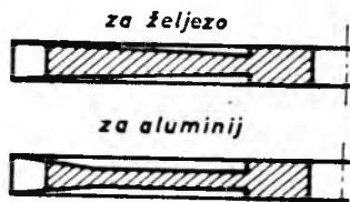
Sl. 69. Presjek zubaca kružnih pila za metale
