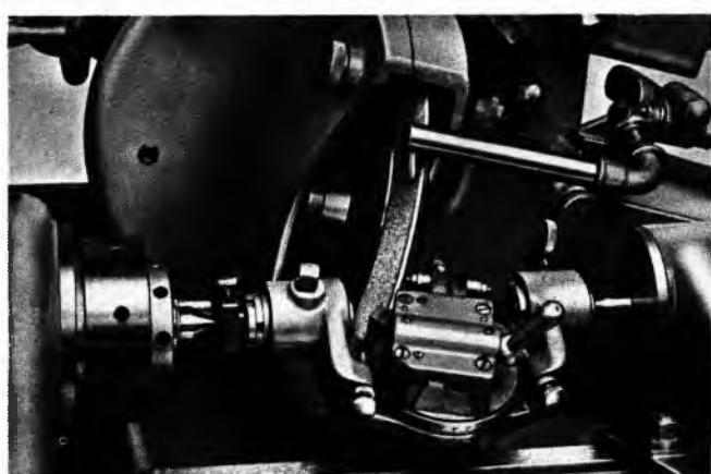
Sl. 201. Uredaj za profiliranje brusne ploče za brušenje puža s pravocrtnim bokom zavojnice u aksijalnom presjeku
