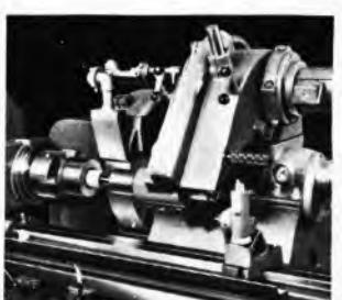
Sl. 148. Vreteno za unutarnje brušenje u radnom položaju s uređajem za oblikovanje brusne ploče vretena za unutarnje brušenje pričvršćenim na zaokretnoj ploči
