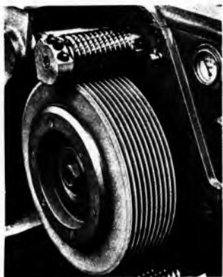
Sl. 194. Pantograf za profiliranje brusne ploče sa povećane šabljone
