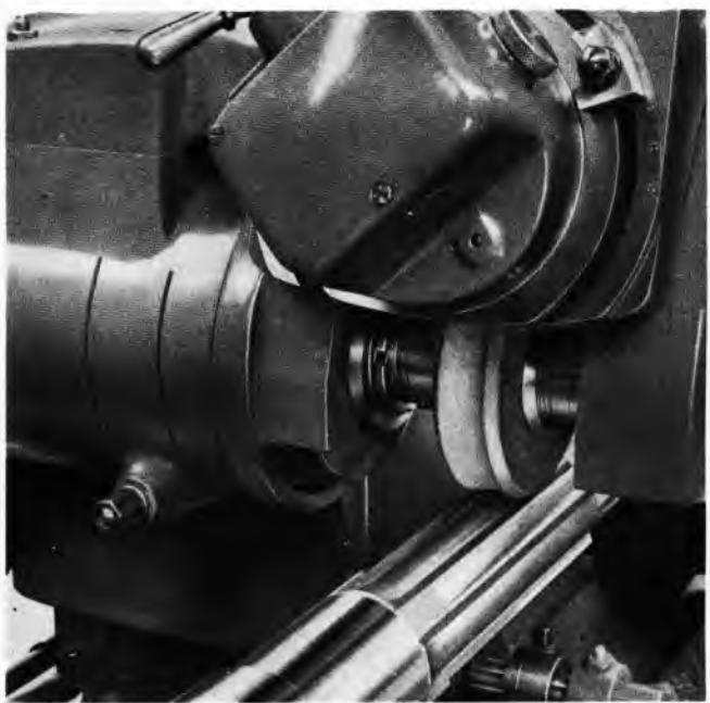
Sl. 174. Brušenje klinaste osovine
