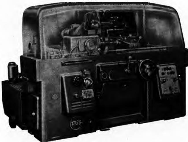
Sl. 189. Brusilica za brušenje navoja, puževa i navojno profiliranih osovina
