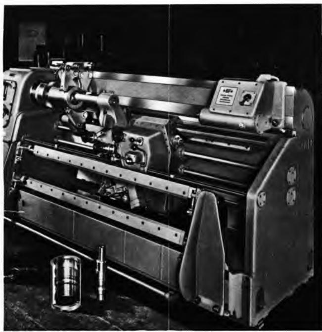
Sl. 81. Kopirna tokarilica. Obrada profiliranog provrta
