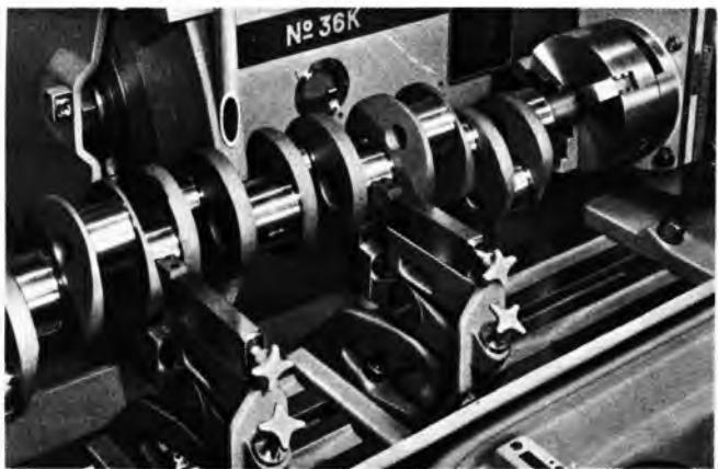
Sl. 163. Brušenje glavnih ležišta radilice na brusilici s uzdužno pomicnim stolom
