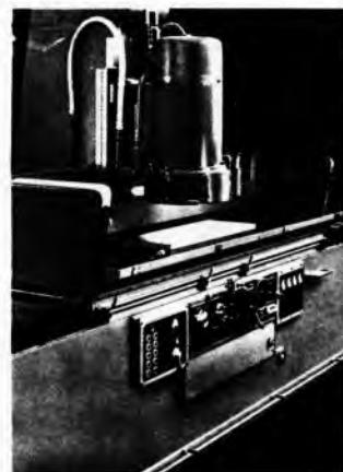
Sl. 200. Brusilica za plosno brušenje čeonim brušenjem
