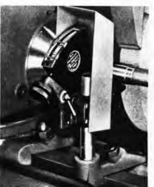
Sl. 149. Mjerilo za upoređno mjerjenje promjera izratka
