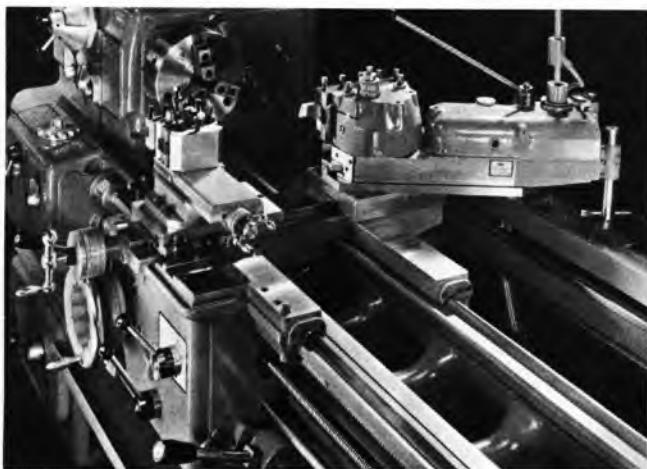
Sl. 78. Hidraulični kopirni uređaj
