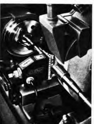
Sl. 150. Mjerni uređaj za mjerjenje promjera izratka vezan za uređaj za automatsko isključivanje rada brusilice po postizanju tražene izmjere na izratku
