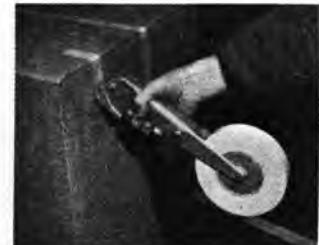
Sl. 42. Ručni alat za lijepljenje papirnate trake
