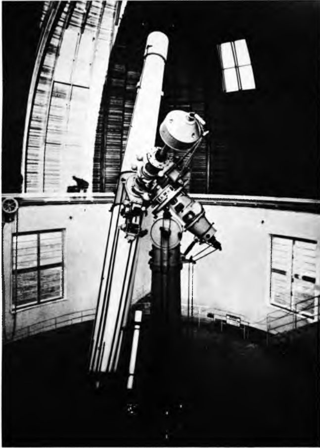
Sl. 8. Veliki refraktor Beogradske opservatorije (otvor 65 cm)
