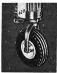
Sl. 330. Prednja osovinica s jednim kotačem
