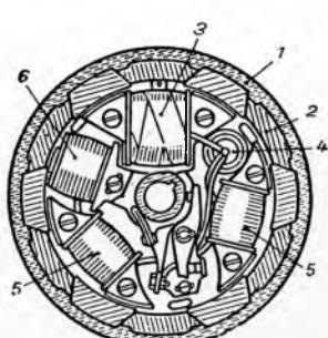
Sl. 280. Zamašni magnet sa generatorima. 1 zamašnjak, 2 magneti, 3 namotaj za paljenje, 4 kondenzator, 5 namotaj za svjetlo, 6 namotaj za punjenje akumulatora
