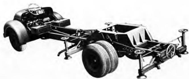
Sl. 317. Podvozje motornih ljestava (Magirus)
