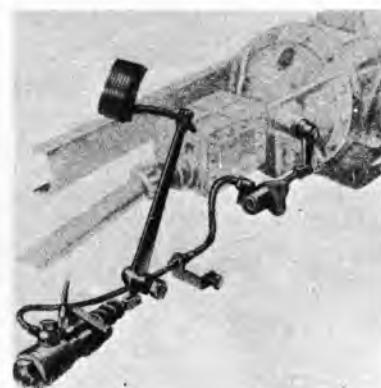
Sl. 32. Hidrauličko aktiviranje spojke
