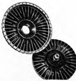
Sl. 39. Kola hidrauličke spojke
