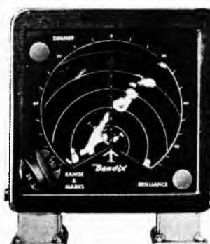
Sl. 103. Slika na ekranu meteorološkog radara
