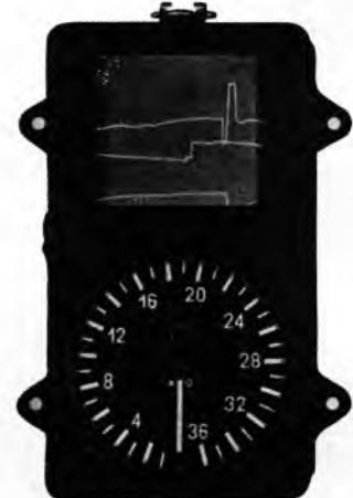
Sl. 9. Registrirajući obrtomer sa brojkama i kazaljkom prevučenom radioaktivnom bojom
