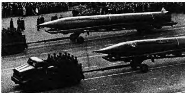
Sl. 6. Sovjetske balističke rakete tipa T-2 za taktičke svrhe (duljina 22 m, masa 25 t, potisak 35 Mp, domet 700 km)
