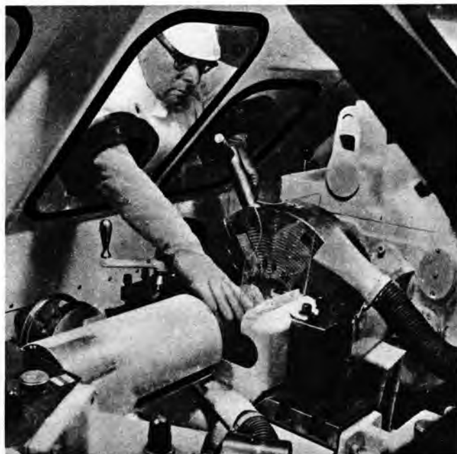
Sl. 5. Obrada berilija na tokarilici
