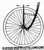
Sl. 19. Ovješavanje prednjeg kotača s tlačnim perom
