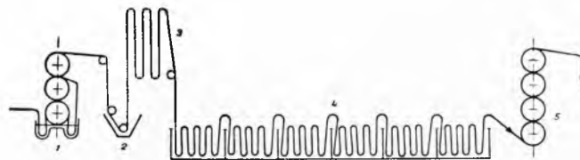
Sl. 23. Uređaj za kontinuirano bojenje tkanina indigosolima. 1 fular za impregnaciju otopinom bojila, 2 fular za razvijanje kiselinom, 3 zračno razvijanje, 4 stroj za široko pranje, 5 bubnjevi za sušenje
