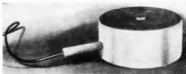
Sl. 12. Elektroakustička tenzometarska kapsula
