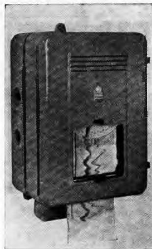
Sl. 20. Pisač dubinomjera. Na traci se vidi profil dna i debeli sloj nanosa
