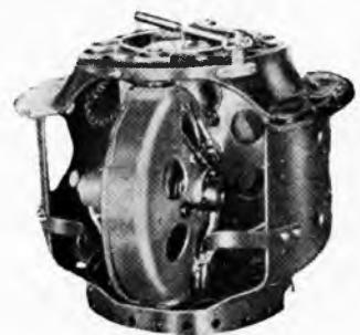
Sl. 10. Matični sistem Anschützova girokompsa. U krletkastom nosaču vide se kućišta dvaju zvirkova pod kutom od 90°. U gornjem dijelu nosača je prstenasta posuda prigušnog sistema. Matični sistem smješten je fiksno u lebdećoj kugli napunjenoj vodikom
