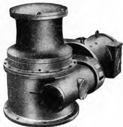
Sl. 3. Električno vertikalno pritezno vitlo pritezne sile 2 Mp (»Vulkan« Rijeka)
