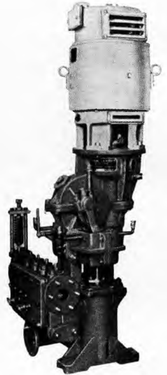
Sl. 25. Dvocilindrična stapna pumpa pokretana elektromotorom preko pužnog prijenosa i koljenaste osovine
