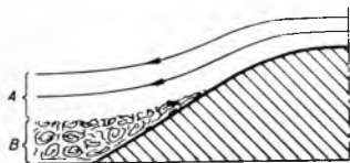
Sl. 3. Otkidanje graničnog sloja na krmi broda. A potencijalno strujanje, B područje vrtložnja
