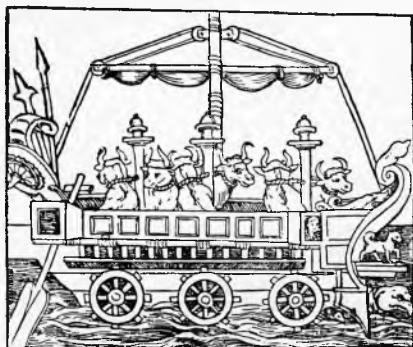
Sl. 2. Brod s bočnim kotačima koje pokreću volovi (oko 1527)
