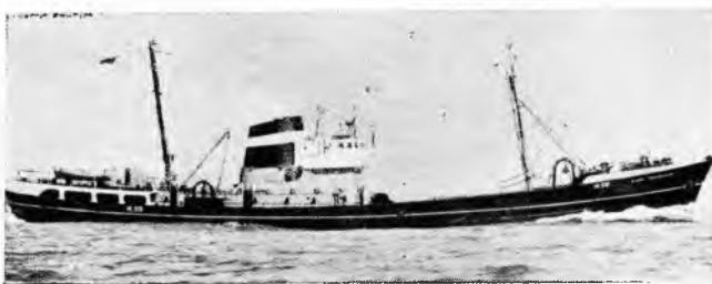
Sl. 17. Dizel-električki kočar za bočno povlačenje mreže »Cap Trafalgar« 800 BRT, 600 KS
