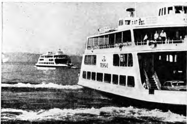
Sl. 15. Simetrični trajekt s Voith-Schneiderovim propelerima na oba kraja trupa
