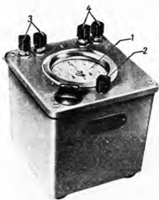
Sl. 29. Jednofazno baždarsko brojilo (proizvod »Compagnie des compteurs«). 1 brojčanik s kazaljka, 2 okretljivo dugme za postavljanje kazaljki brojčanika u nulti položaj, 3 stezaljke za naponsku stazu, 4 stezaljke za strujnu stazu
