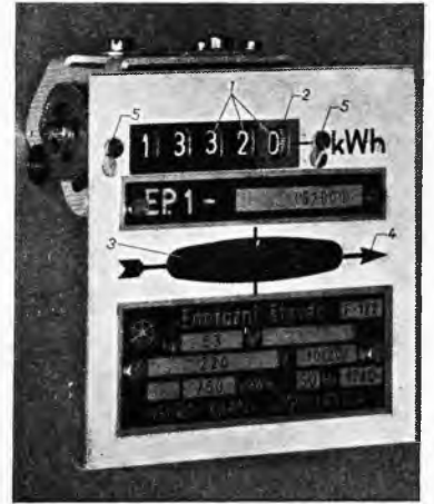
Sl. 2. Brojčanica i brojčanik s valjkastim koturićima. 1 valjkasti koturići, 2 koturić najnižeg mjesta, 3 otvor za promatranje diskosa, 4 strelica koja pokazuje smjer vrtnje diskosa, 5 vijci za pričvršćenje brojčanice
