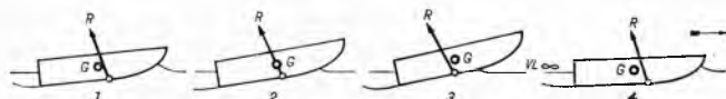
Sl. 89. Ponašanje glisera kod poskakivanja. R = rezultirajuća hidrodinamička sila; l moment rezultirajuće hidrodinamičke sile izdiže pramac, čamac se propinje i prelazi preko ravnotežnog položaja 2 u položaj 3 u kojem moment hidrodinamičke sile izdiže krmu i ponovo dovodi čamac u početni položaj 4 s momentom izdizanja pramca
