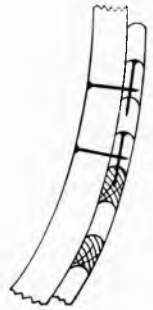
Sl. 13. Oplata od letvice. Letvice se zabijaju iznutra kroz rebra, a među rebrima jedna u drugu
