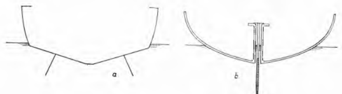
Sl. 55. Peraje. a Bočne peraje, b pomična peraja u sanduku
