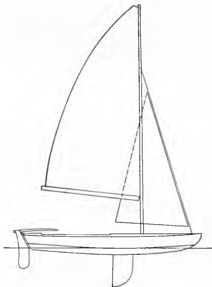
Sl. 56. Deplasmanski čamac »Šljuka«; L_{OA} = 4,72 m, B = 1,54 m, \Delta = 192 kg, jedrilje 11,4 m 2
