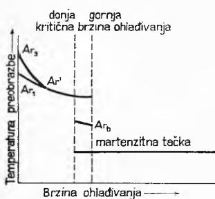
Sl. 15. Zavisnost preobražajnih temperatura od brzine ohlađivanja
