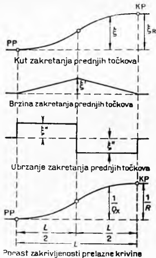
Sl. 7. Dijagram kuta zakretanja, brzine i ubrzanja zakretanja prednjih točkova vozila u prelaznici kojoj se polumjer zakrivljenosti mijenja nelinearno
