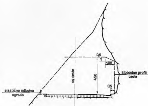
Sl. 41. Poprečni presjek kroz galeriju
