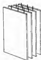
Sl. 22. Pločasti elektrostatički precipitator
