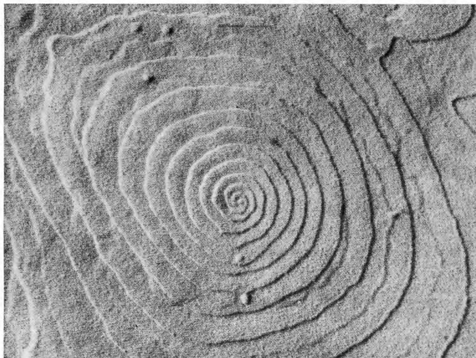
Sl. 3. Ploha kristala polietilen-oksida u rastu oko vijčane dislokacije. Povećanje ~ 50000×
