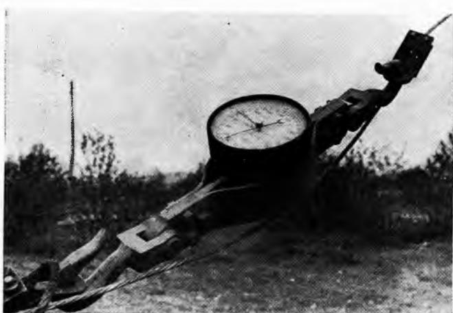
Sl. 64. Dinamometar za mjerjenje sile u vodiču
