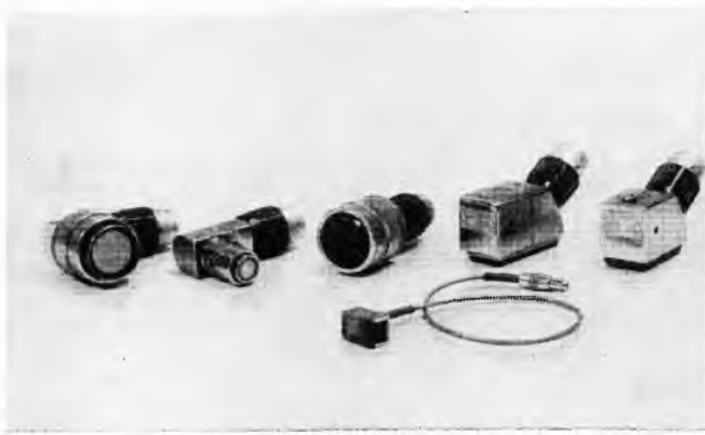
Sl. 25. Nekoliko tipova ultrazvučnih vibratora (Krautkrämer, Köln)
