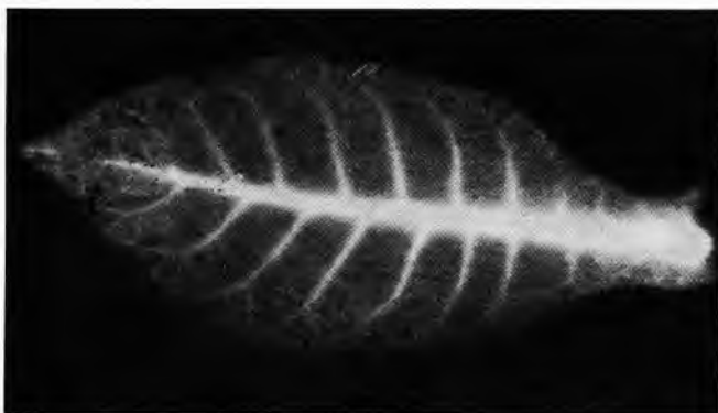
Sl. 12. Integralno dejstvo zračenja na fotografsku emulziju: list biljke sa apsorbiranim radioaktivnošću u žilama
