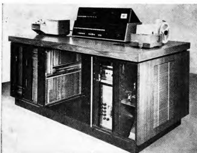
Sl. 38. Digitalno računačko u stolnoj izvedbi. Na stolu vide se sljeva nadesno: čitač perforirane trake, upravljački pult i kao izlaz bušač perforirane trake. Svi ostali dijelovi, koji su većinom izrađeni u mikrominiaturnoj tehnici s epitaksijalnim planarnim silikonskim poluvodičima, smješteni su u samom stolu
