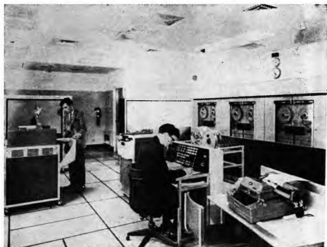
Sl. 40. Veliko digitalno računačko opće namjene prilagođeno za privredu. Na slici lijevo: brzi pisač, u sredini: upravljački pult, desno: običan pisač, straga memorije s magnetskim trakama
