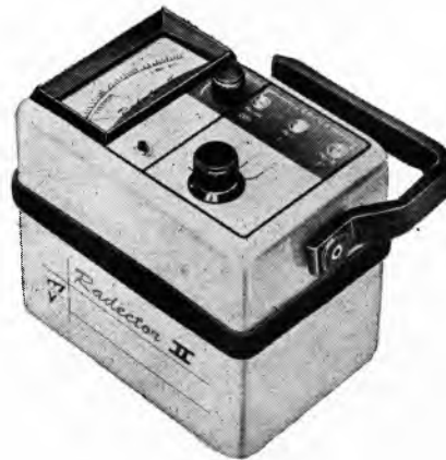
Sl. 3. Dozimetar sa jonizacionom komorom Radoctor II (Victoreen, USA). Regstruje \beta - i \gamma -zračenje u području 0,1 mR/h ... 100 mR/h, 0,1 R/h...100 R/h i 0,1 kR/h...1 kR/h
