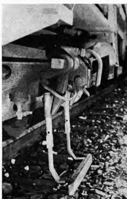
Sl. 22. Oduzimač struje za strujnu tračnicu
