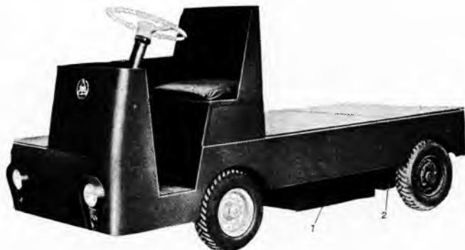
Sl. 2. Akumulatorsko radioničko vozilo (Rade Končar, tip EKS 3). 1 Akumulatori, 2 pogonski motor
