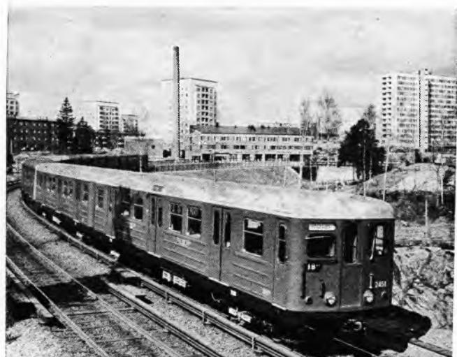
Sl. 9. Kompozicija podzemno-nadzemne gradske željeznice Stockholma (proizvod ASEA). Vide se kontaktne šine, a na vagonima pripadni oduzimači struje i veliki broj vrata
