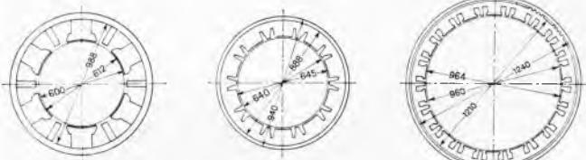
Sl. 38. Sporedba glavnih dimenzija triju vučnih motora građenih za različne vrste struje i različite frekvencije. a - 6-polni motor za istosmjernu struju 650 KS, 645 o/min, 4300 kp; b - 10-polni motor za izmjeničnu struju  $16\frac{2}{3}$  Hz, 720 KS, 1070 o/min, 2500 kp; c - 18-polni motor za izmjeničnu struju 950 KS, 955 o/min, 4400 kp.
